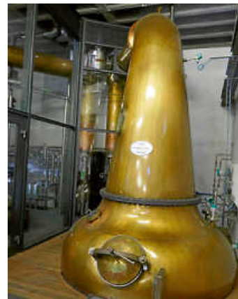
In zwei riesigen Brennblasen wird der Whisky in St. Kilian gebrannt.
