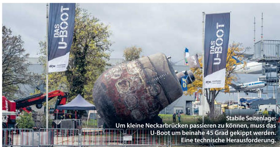
Stabile Seitenlage: Um kleine Neckarbrücken passieren zu können, muss das U-Boot um beinahe 45 Grad gekippt werden. Eine technische Herausforderung.
